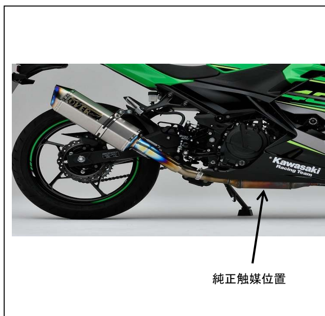
製品と純正触媒の取付写真
