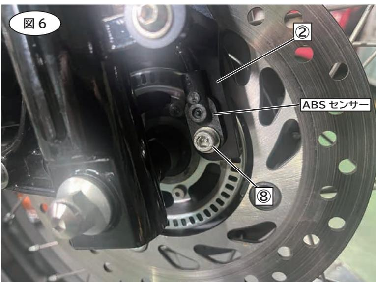
10. 全てのボルトの締め付け状態やブレーキホース及びハーネスの取り付け状態を確認してからテスト走行し、再度各部の固定状況や干渉がないかを確認し、安全が確認できれば作業終了です。定期的に安全確認は行なうようにしてください。
